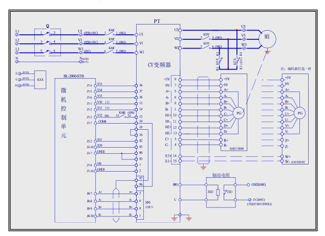
CV 变频器 注:编码器任选一种 微机控制单元 制动电阻 CV inverter Note: choose one encoder Computer control unit Brake resistor
