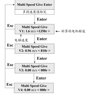
多段速度值给定 multi speeds values reference 折算的电机转速 commuted motor rotary speed 电梯速度 elevator speed
