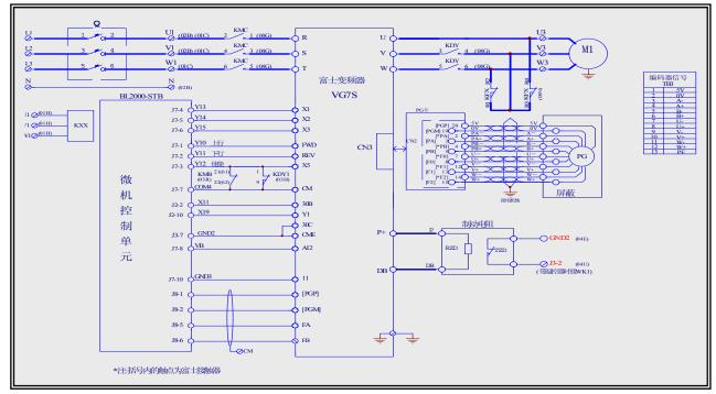
富士变频器 微机控制单元 屏蔽 编码器信号 制动电阻 带温控器时接 WK1 注:括号内触点为富士接触器
